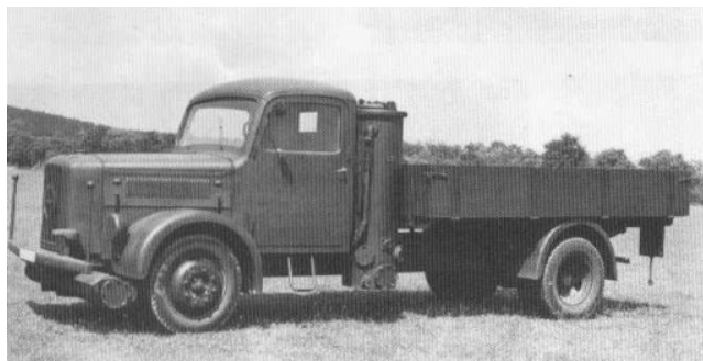
Eksempel på lastvogn med påmonteret gasgenerator
